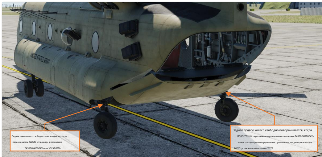
4-колесное наземное такси – гидроусилитель руля
