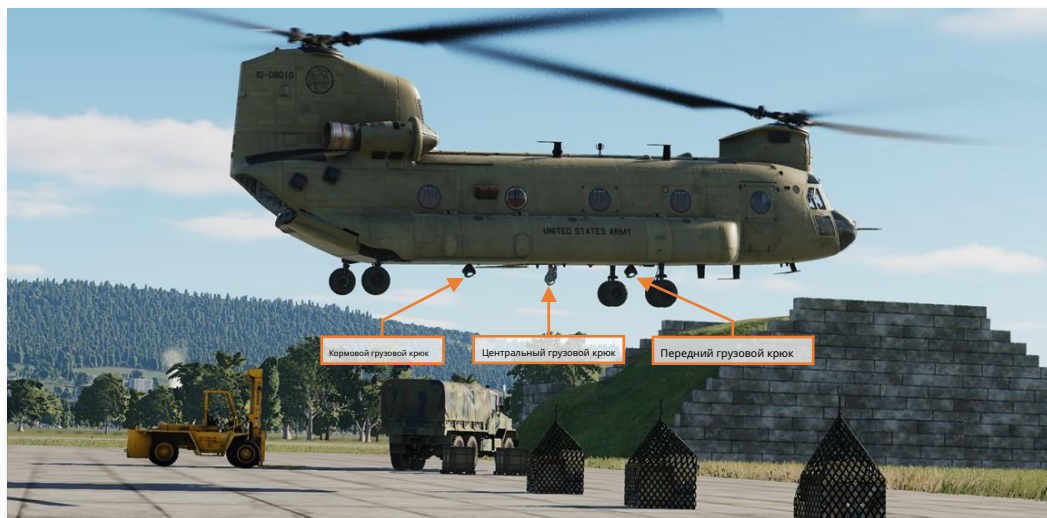
Тройная система грузовых крюков
